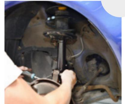
11. Ziehen Sie im letzten Schritt nochmals die Muttern am Federbeinstützlager und Stoßdämpfer fest. Wichtig: Nach dem Wechsel eines Stoßdämpfers oder eines ebenfalls im Sortiment Jakoparts erhältlichen Federbeinstützlagers oder einer Fahrwerksfeder, ist eine Achsvermessung unbedingt erforderlich!
