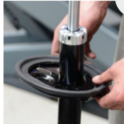
8. Tauschen Sie am besten alle Gummiteile aus und verbauen Sie diese auf den neuen Stoßdämpfer von Herth+Buss. Wichtig: Achten Sie bei der Montage des Federbeintellers darauf, dass die Führungsaufnahme auf der des Stoßdämpfers sitzt.
