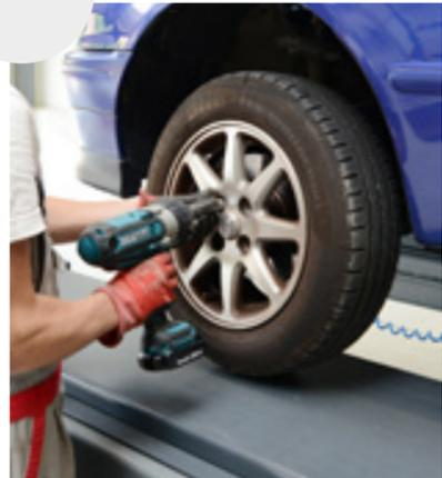
2. Heben Sie das Fahrzeug an und demonstrieren Sie das Rad.
