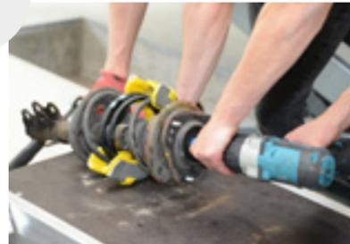
6. Spannen Sie im nächsten Schritt das Federbein mittels Federspanner. Sofern die Feder genügend durch den Federspanner gespannt ist, kann die Mutter vom Federbeinstützlager gelöst und das Federbeinstützlager samt Federbeinteller abgenommen werden.
