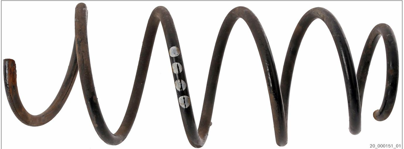
Abb. 2 Gebrauchte Fahrwerksfeder mit Farbmarkierung (Beispiel)
