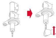
Obrócić amortyzator podstawą do góry, ścisnąć plec razy, a następnie zwolnić.
