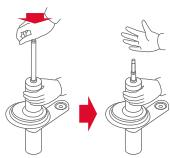
Comprima totalmente o veio do amortecedor e depois solte-o.
