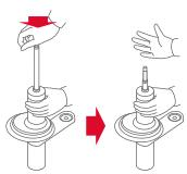
Comprima el vástago del pistón completamente y, a continuación, suéltelo.
