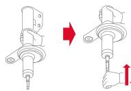
Dé la vuelta al amortiguador boca abajo, comprímalo cinco veces y suéltelo.
