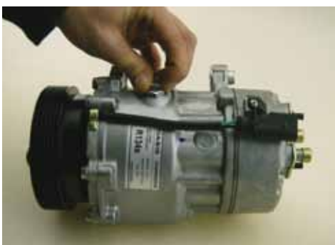
7. Ablafschraube mit Dichtung wieder einschrauben
