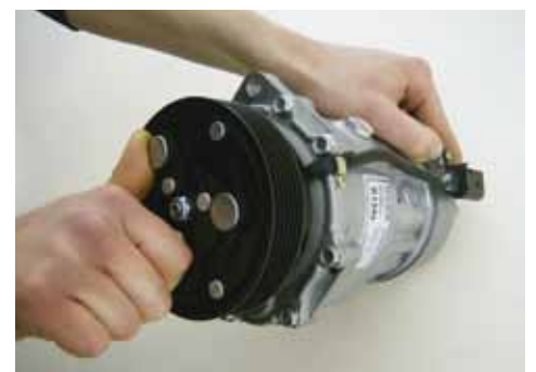
9. Kupplung des Kompressors 5 x per Hand drehen um das Öl gleichmäßig zu verteilen
