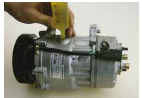
6. Aufgefangene Ölmenge auf Herstellerangabe anpassen
